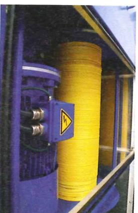
Eine Seilwinde auf der Ladefläche eines Lkw, die die riesigen Fluggeräte bis zu 500 Meter aufsteigen lässt und sie dann wieder einholt.
