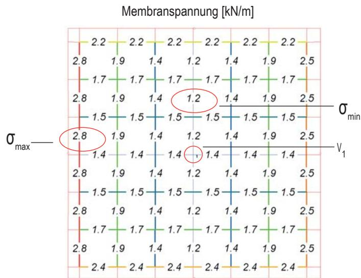
Als Ergebnis der ersten Tragstudie kann ein hybrides Tragverhalten des Membranmoduls festgestellt werden, da sich Membran und Rahmen gegenseitig beeinflussen: Die Membranvorspannung bewirkt eine allseitige Rahmenverformung, die wiederum die Vorspannung der Membran reduziert. Nach dem Einstellen eines Kräftegleichgewichts treten die größte Rahmenverformung und die niedrigste Membranspannung in Feldmitte auf. Die Ergebnisse im Einzelnen:
