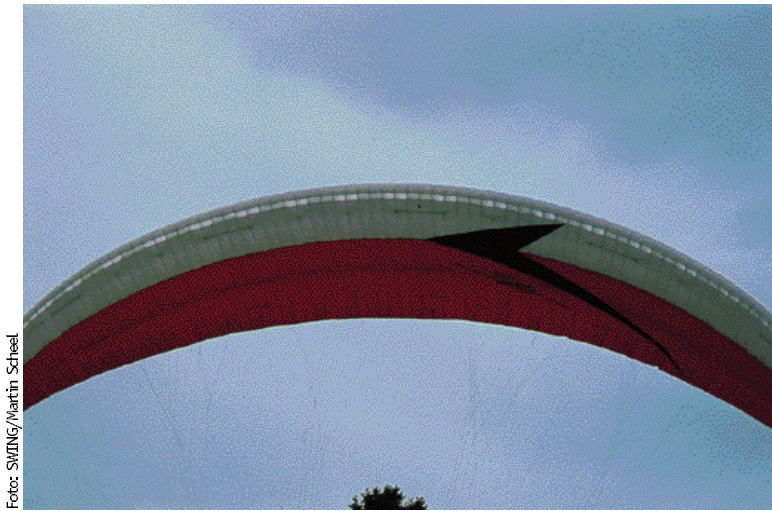
Große Streckung beim SWING Stratus (li.); der extrem gestreckte Experimentalschirm mit aufblasbarem Luftschauch von Paradelta Parma (re.) konnte sich am Markt dagegen nicht durchsetzen
